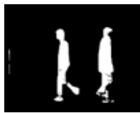
Figure 4. Résultat de la relaxation markovienne avec un seuillage par hystérésis
